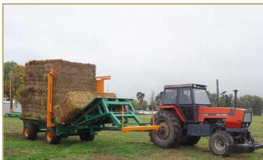
Figura 19: Carro recolector de Megafardos Agromec (capacidad de apilar 14 unidades).
