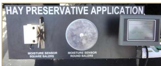
Figura 10: detalle del sensor de humedad.
