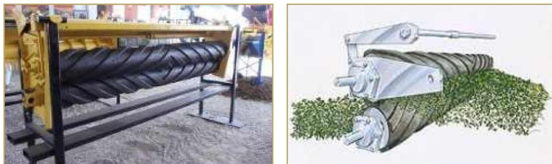
Figura 12: Esquema de trabajo de un sistema de acondicionado mediante rodillos.
