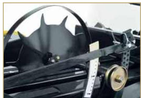
**Figura 7:** rueda dentada que mide los movimientos del megafardo dentro de la cámara (CNH, 2011)
