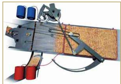
**Figura 6:** detalle del sistema de atado (CNH, 2011)
