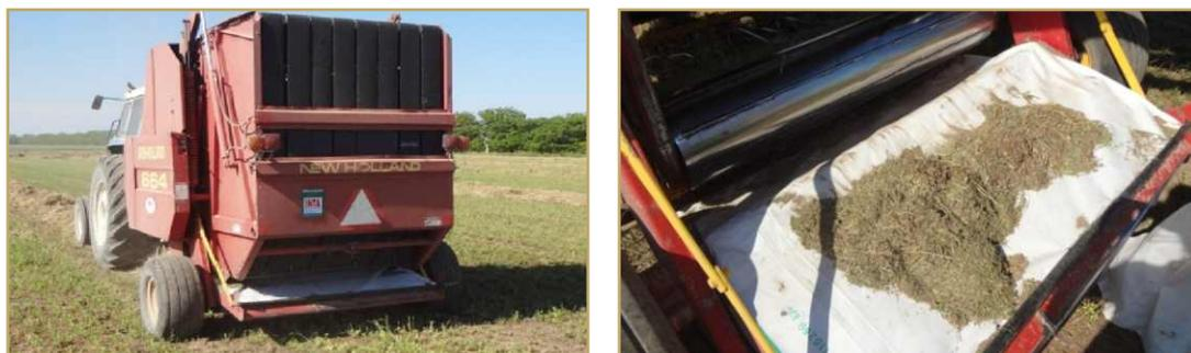
**Figura 16:** Medición de pérdidas en cámara de compactación en Rotoenfardadora New Holland 664.
