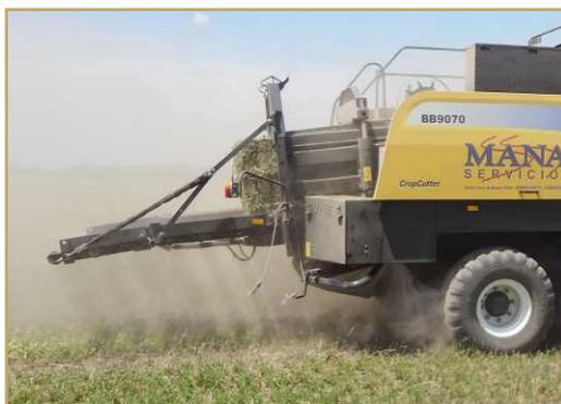
Figura 8: detalle de la rampa de descarga.
