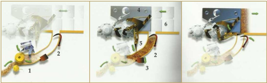
**Figura 4:** Esquema que muestra el proceso de alimentación de la cámara de compactación (CNH, 2011)
